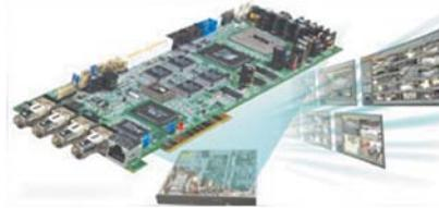
VioCard-100 поддерживает различные типы видеокамер. На плате имеется процессор, память, Ethernet и установлено программное обеспечение (операционная система и драйвера). Видео
