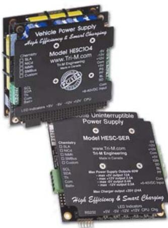
Ведущий производитель устройств для встраиваемых применений - компания Tri-M Engineering, Канада, выпустила интеллектуальные модули источников питания мощностью 60Вт с управлением по шине ISA и по каналу RS-232.
