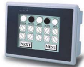
Touch 200/200S топо 5.7" STN, 320x240 видимая область 120x90 мм габ. размер 204x150x75 мм защита передней панели IP 65 питание 21-28В/220мА
