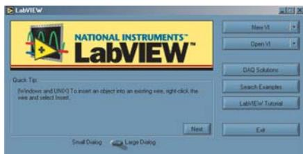
утилиту для конфигурирования устройств сбора данных и их связи с VI (DAQ Solutions) или вызвать обучающую систему базовым приемом программирования (LabVIEW Tutorial). В поставку пакета входит большое количество разнообразных примеров, иллюстрирующих различные возможности LabVIEW. Каждый из этих примеров может быть запущен на исполнение, а его код (или часть) может быть использован для разработки приложения пользователя. Все это очень помогает быстрее применить пакет для конкретных задач.
