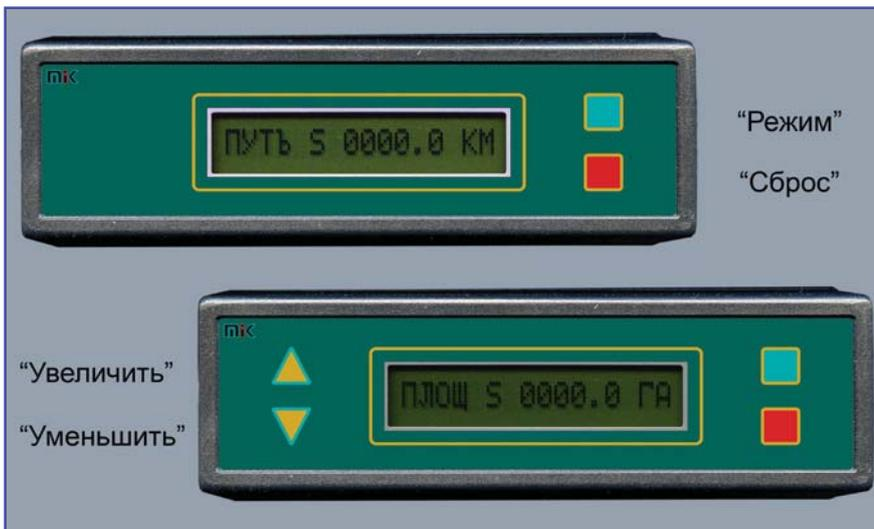
Контроллер KPM-2 отличается от KPM-1 более широким набором поддерживаемых функций. В нем добавлены функции вычисления суммарного и текущего значений обработанной площади, а также предусмотрена возможность ввода ширины захвата рабочего органа машины. Обработанная площадь отображается в гектарах. Для этого в состав KPM-2 включен датчик положения рабочего органа машины, увеличено количество кнопок на клавиатуре и, конечно, доработано программное обеспечение.
