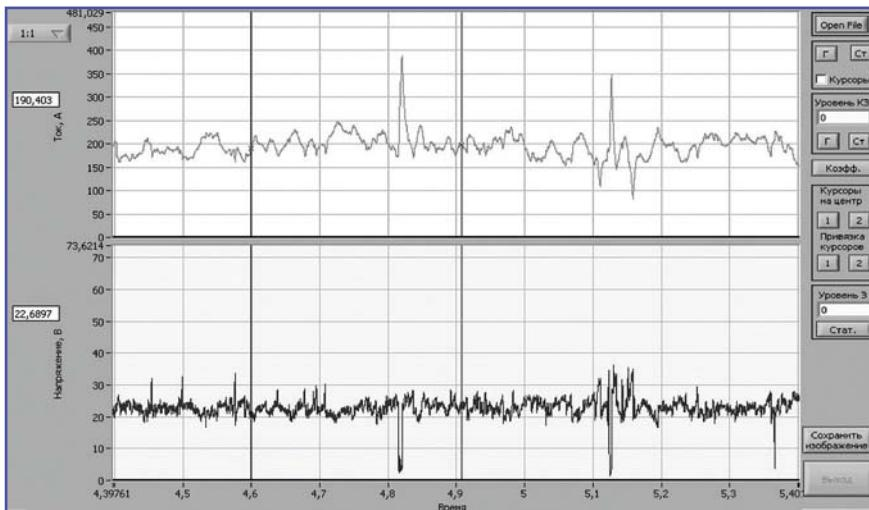
Для исследуемого участка осциллограммы могут быть получены также вольтамперная характеристика, рассчитаны частоты с помощью преобразований Фурье и скорость нарастания тока.
