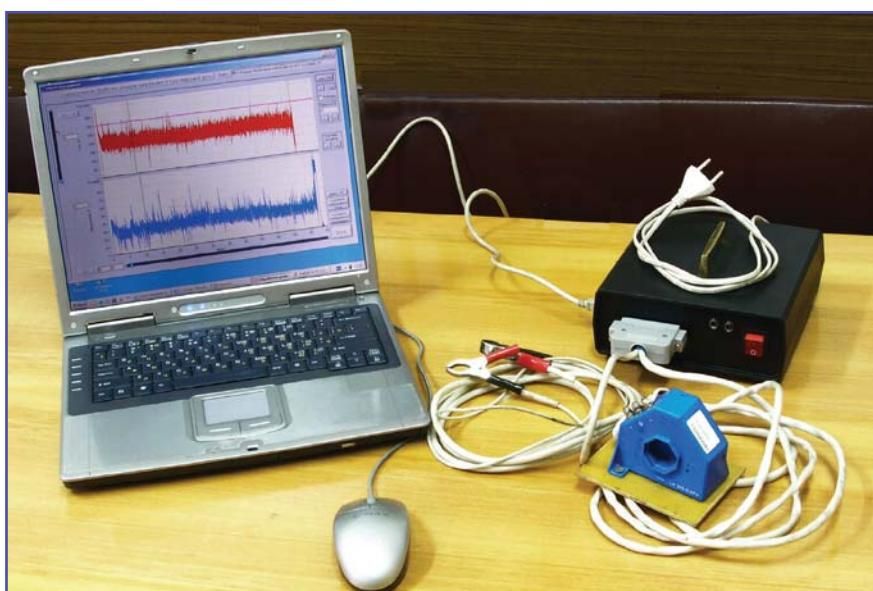
гистограмм. При этом определяются среднее и среднеквадратическое значение, стандартное отклонение, дисперсия, мода и медиана сигнала, коэффициент вариации, значения минимума, максимума и размаха сигнала, и объем массива данных. Пользователю предоставлена возможность выбора необходимых параметров и сохранения изображения гистограммы амплитудных значений сигнала.
