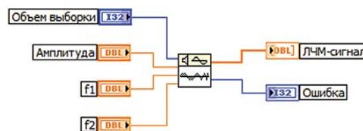
Входы **f1** и **f2** определяют минимальное и максимальное значение частоты ЛМЧ-сигнала, т.е. значения, в пределах которых будет изменяться частота выходного сигнала. Эти значения задаются в нормированных единицах: отношение частоты к частоте дискретизации. Иными словами, они определяют, сколько точек будет приходиться на один период сигнала. Например: если установить значение 0.1, то за период будет получено 10 точек.
