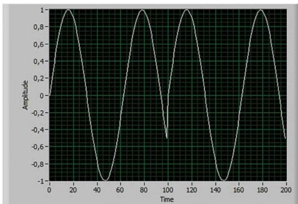
Попробуйте изменить значение **Сброс фазы** на FALSE и запустите программу. Вы увидите, что срывов сигнала уже не наблюдается. Это объясняется тем, что начальная фаза сигнала всегда устанавливается равной выходной фазе при последней генерации, что и позволяет получать непрерывный сигнал.
