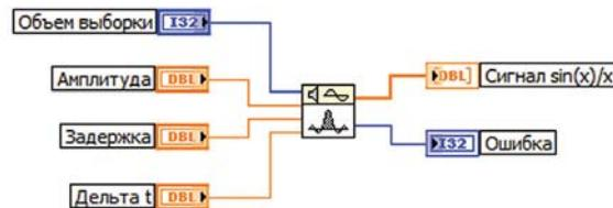
Вход **Задержка** определяет место расположения центрального лепестка функции. Индекс максимального значения функции  $\sin(x)/x$  определяется из соотношения:
