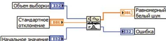
На выходе VI формирует псевдослучайную последовательность с нормальным распределением и заданным **Стандартным отклонением**. По умолчанию параметр отклонения равняется единице.
