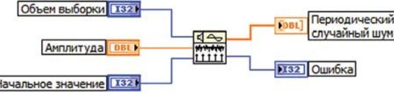
В выходном массиве присутствуют все частоты, которые могут быть представлены целым числом периодов, исходя из установленного **Объема выборки**. Амплитуды периодических сигналов указываются на соответствующем входе, а фазы выбираются случайным образом. Вот такой непростой шум получается.
