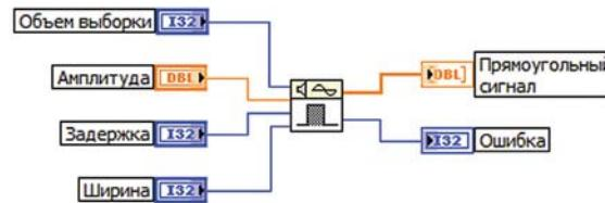
VI **Pulse Pattern** поможет Вам сгенерировать отрезок прямоугольного сигнала. Его вход **Задержка** определяет передний фронт сигнала (индекс первого элемента, имеющего высокий уровень), а **Ширина** - устанавливает количество отсчетов, для которых уровень сигнала будет высоким. Следует еще заметить, что сумма значений задержки и ширины не должна превышать количество отсчетов в выборке.
