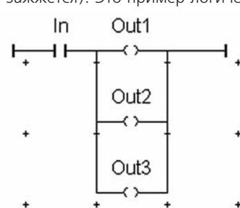
контакта переходит из состояния *FALSE* в состояние *TRUE*, то есть в момент положительного фронта сигнала переменной *In*. Во всех остальных случаях контакт "закрыт". В итоге, "лампа" *Out* "мигнёт" только если "включить" контакт *In*. Чтобы она мигнула ещё раз, нужно контакт "выключить" и затем снова "включить" (то есть перевести переменную *In* из *TRUE* в *FALSE*, а затем обратно в *TRUE*).
