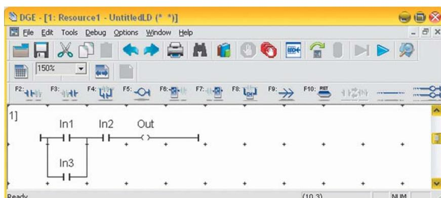
логических элементов цепи, которые являются ключи и витки. Ключ представляет собой контакт, который управляет определенной булевой переменной. Виток же наоборот - изменяет состояние присвоенной ему булевой переменной. Если проводить сравнение с электрической цепью, то ключ на ней - это выключатель, а виток - лампочка. Вся выстроенная цепь
