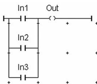
При данном соединении виток **Out** примет значение **TRUE**, если хотя бы один из контактов In1, In2, In3 будет
