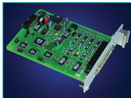
Модуль системы LTR для виброакустических измерений LTR22 (L-Card, Россия). Четыре независимых канала с дифференциальным входом, каждый из которых имеет: сигма-дельта АЦП, встроенный автоматический фильтр нижних частот для ограничения полосы сигнала на уровне -75 дБ, программно отключаемый фильтр верхних частот для устранения постоянной составляющей сигнала на частоте 0,3 Гц.
