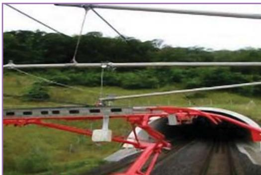
Задача состояла в измерении вертикального отклонения провода, возникающего в момент прохождения токосъемника такой контактной точки, а также возникающую в результате этого вибрацию. Для проведения таких испытаний департамент привлек исследовательскую инженеринговую компанию Arlica (Вена, Австрия).
