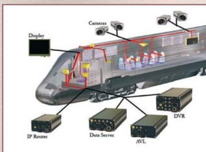
ные средства могут содержать некоторые или все распределенные подсистемы M2i™ для реализации систем беспроводной связи, сбора данных, GPS позиционирования, обеспечения безопасности и коммуникаций нового поколения. Интегрируя ро-
