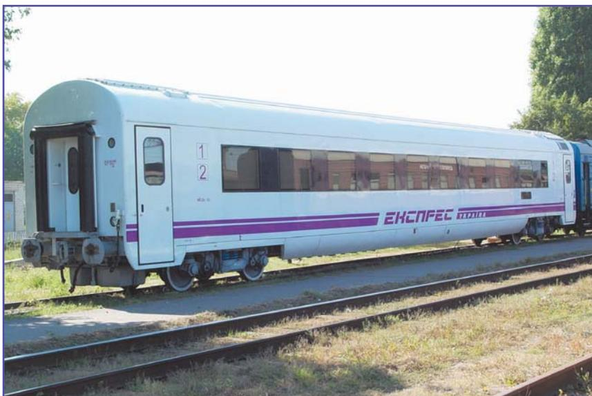
вагон модели 61-788, производства ОАО "КВЭС" с централизованной системой электроснабжения
