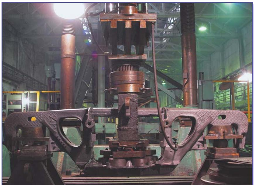
стендовый участок усталостных испытаний
