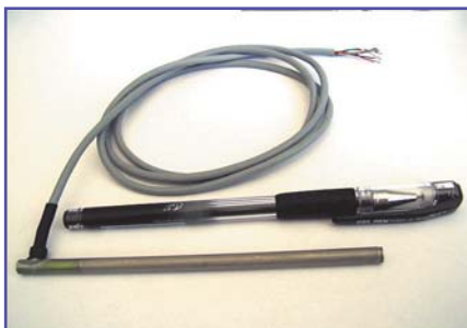
миниатюрный датчик линейных перемещений 0..70 мм
