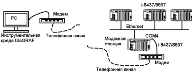
Схема взаимодействия среды разработки с контроллерами в режиме дистанционной загрузки и отладки
