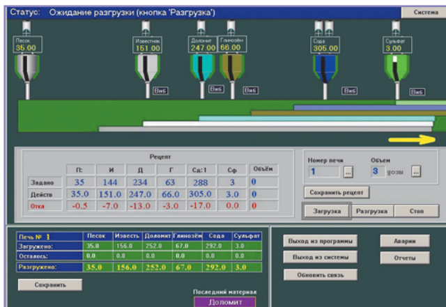
Мнемосхема техпроцесса стекольного производства. г.Буча, Киевская обл.
