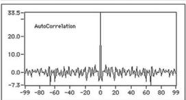
В VI 1D Autocorrelation (DBL) и 1D Autocorrelation (CDB) имеется вход управления *normalization*, позволяющий выполнить нормирование АКФ со смещением и без него.
