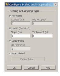
Если Вам нужно логарифмическое сжатие сигнала, используйте режим **Logarithmic:**  $Y_i$ =20 $log_{10}(X_i/db reference)$ .
