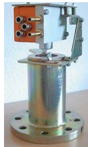
ВБО с инфракрасным фильтром, установленный на фланце для водяного охлаждения
