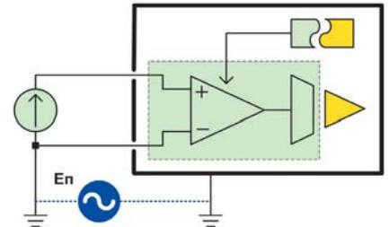
Гальваническая развязка позволяет не только защититься от помех общего вида, но и защитить человека от поражения электрическим током. Разделение может быть либо в аналоговом виде (усилители с гальванической развязкой), либо в цифровом виде. Выпускаемые усилители с гальванической развязкой обеспечивают подавление помехи общего вида синфазного сигнала от 100 до 170 дБ и их пробойное напряжение сопротивления изоляции лежит в пределах от 200 до 6000 В.
