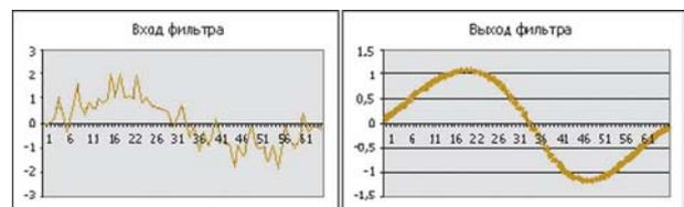
При измерении сигналов постоянного уровня, например, напряжений постоянного тока широко применяется такой вид фильтрации, как интегрирование. Интегрирование используется для уменьшения влияния периодических (гармонических) помех, наводок с частотами питающих сетей. В результате интегрирования суммы постоянного сигнала  $X$  и гармонической помехи  $U \sin \omega t$ , за время, кратное периоду помехи  $nT$  ( $T = 2\pi/\omega$ ), влияние помехи полностью исключается:
