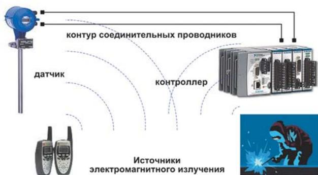
наводки от силовых кабелей, наводки от коммутационных процессов, наводки от излучений радиостанций, перекрестные наводки от других измерительных цепей. Такие помехи имеют преимущественно аддитивный характер и называются, также - дифференциальными, так как по-разному действуют на входы измерительного устройства.
