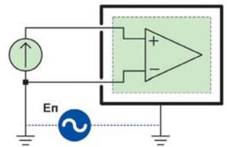
Для построения устройств гальванической развязки обычно используются высокочастотные трансформаторы с малой проходной емкостью, высоковольтные конденсаторы малой емкости, оптронные пары или преобразователи на основе магниторезисторов.
