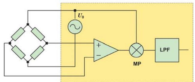
помехи, с частотами, отличными от  $\omega$  - частоты источника напряжения питания ( $U_0 = U_m \cdot \sin \omega t$ ), полностью устраняются. Здесь полезно вспомнить свойства системы ортогональных сигналов. Например, если в измерительной цепи действует помеха  $U = U_n \cdot \sin \omega_p t$ , то на выходе умножителя появится составляющая  $(U_m \cdot \sin \omega t) \cdot (U_n \cdot \sin \omega_p t)$ , а на выходе фильтра действие этой составляющей будет определяться соотношением:
