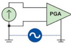
Например, при грозовых разрядах в цепях электроснабжения могут возникать выбросы напряжения от 10 до 20 кВ. Поскольку защитное заземление представляет собой цепь возврата тока с низким импедансом, паразитные выбросы напряжения по цепям электроснабжения могут наводить в контуре заземления броски токов значительных амплитуд, вызывая кратковременные изменения разности потенциалов в его цепи величиной до сотен вольт и длительностью от единиц до сотен миллисекунд.
