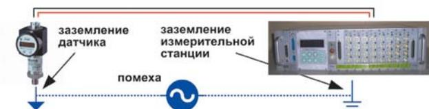
Такие помехи еще называют синфазными (по характеру воздействия на входы измерительного устройства). Синфазные помехи могут иметь место и в пределах небольшой электронной схемы на печатной плате, и в протяженной измерительной цепи в условиях промышленного производства. Если в первом случае уровень таких помех обычно не превышает единиц мВ, то во втором случае - уровень продольных помех может достигать сотен вольт.
