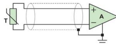
ство **A** (инструментальный усилитель) заземлено - экран подключается к общей точке схемы (земле) возле измерительного устройства.
