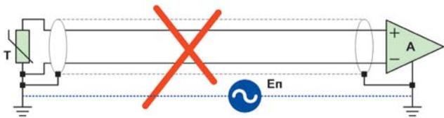
**Симметрирование измерительной цепи** существенно уменьшает влияние помехи общего вида (синфазной помехи). Суть симметрирования заключается в использовании дифференциальной схемы подключения входной цепи измерительного устройства.
