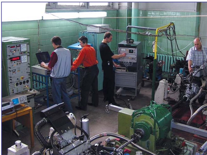
Подготовка двигателя к испытаниям
