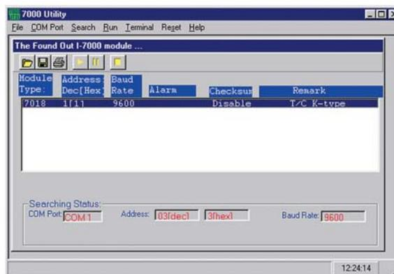
Далее следует дважды щелкнуть левой клавишей мыши на выделенном синей полосой модуле i-7018. Появится окно для установки необходимых дополнительных параметров:
