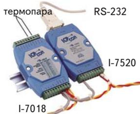
подключим один модуль АЦП для термпар i-7018 к коммуникационному порту компьютера. Модули сбора данных i-7000 имеют интерфейс RS-485, поэтому нам потребуется преобразователь интерфейса RS232/RS485, например, модуль i-7520. А ко
