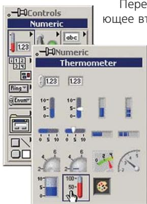
Переключаемся в окно, соответствующее второй закладке. Размещаем термометр и графический индикатор для поточечного построения зависимости. Создаем в интерфейсном окне или в окне редактирования диаграмм кнопку "STOP" для завершения работы с программой. Она же будет определять выход из цикла.
