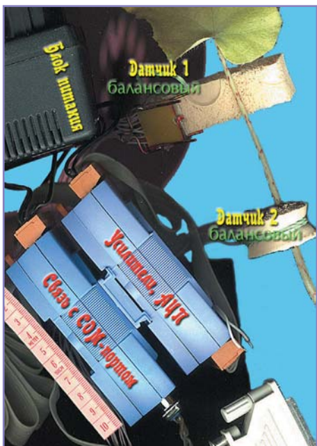
Система измерения ксилемного потока "Adonis" на объекте.
