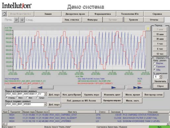
Рис.8. Экран просмотра исторических данных и сводки тревог демо-системы iFIX
